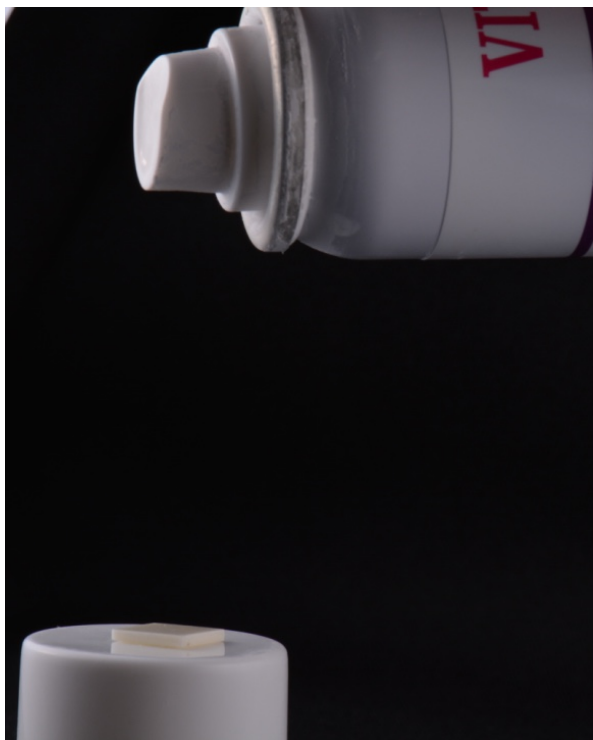
Figura 4 –Vitrificação da cerâmica Y-TZP
