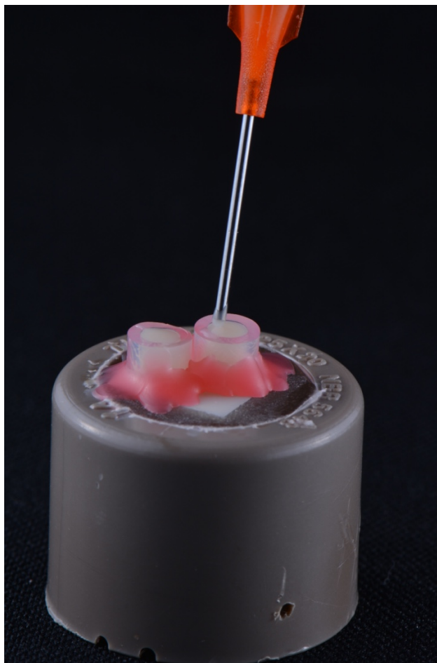
Figura 8 – Inserção do cimento resinoso no interior dos tygons
