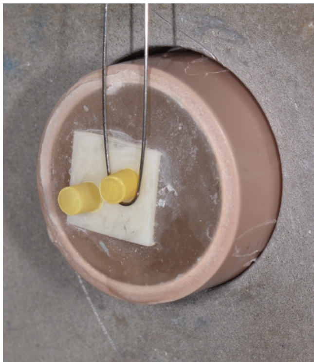
Figura 11 – Amostras prontas para realização do microcisalhamento
