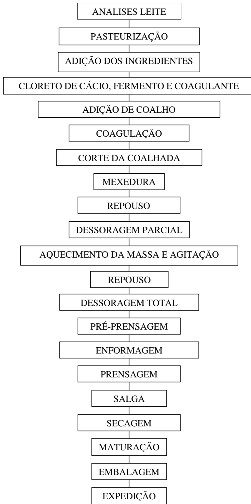
Figura 3 Fluxograma de fabricação do queijo Gouda. Fonte: (Próprio autor).
