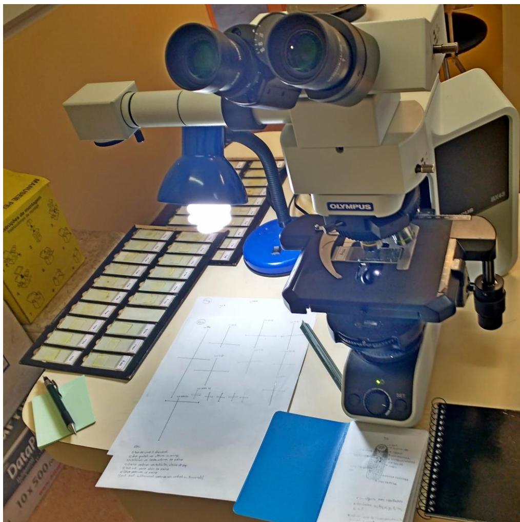
Figura 13: Fotografia de morfometria de trematódeo digenético de Sibynomorphus newwiedi com o uso de microscópio óptico com câmara clara acoplada
