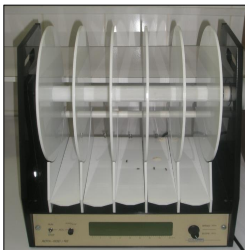
Figura 11: Aparelho do teste da barra giratória – rotarod (modelo LE 8200, Panlab R ) para observação de coordenação motora
