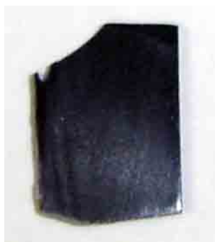
Figura 7.28: Foto do vidro originado do simulado de solo lunar JSC-1 que foi usado para a caracterização térmica.
