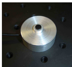
Figura 3.13: Suporte do microfone que possibilita estabilidade na medida.
