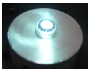
Figura 3.19: Amostra recebendo luz para geração do sinal fotoacústico.
