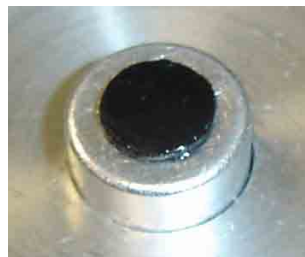
Figura 3.2: Montagem da amostra no topo do microfone de eletreto em uma configuração de célula aberta.
