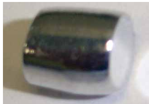
Figura 7.1: Foto da amostra de alumínio com 99,99% de pureza da qual foi feita as amostras para adequação das técnicas.
