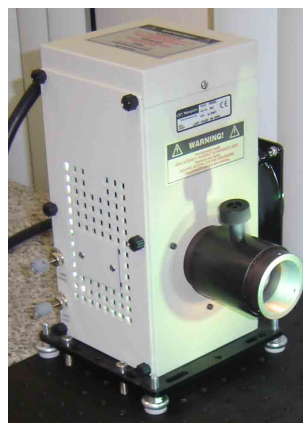
Figura 3.7: Lâmpada de arco xenônio de 500 W de potência utilizada na montagem da OPC.
