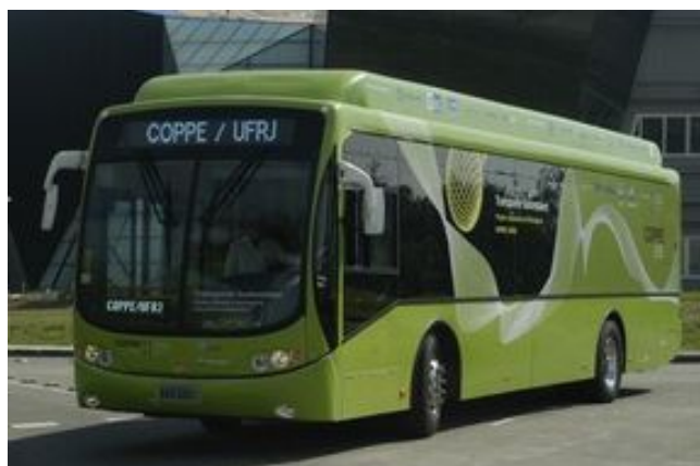
Figura 6: Ônibus elétrico a hidrogênio desenvolvido pela COPPE/UFRJ (foto retirada de www.planeta.coppe.ufrj.br )
