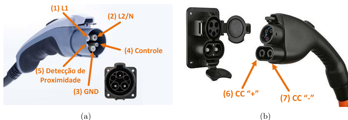
Figura 46: Conectores padrão SAE J1772: (a) Métodos de recarga “CA Nível 1”, “CA Nível 2” e “CC Nível 1” (adaptação de foto retirada de www.carstations.com ); (b) “Combo”: suporta todos os métodos de recarga (adaptação de foto retirada de ev.sae.org/article/10128 ).
