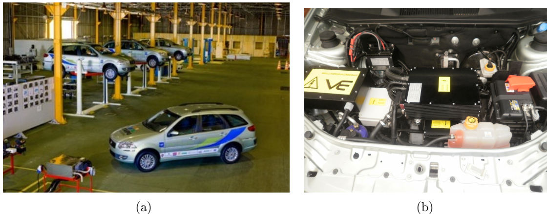
Figura 7: Palio elétrico desenvolvido em parceria pelas empresas Itaipu Binacional, Fiat e KWO: (a) Foto do veículo; (b) Detalhe apresentando sistema eletrônico do veículo.
