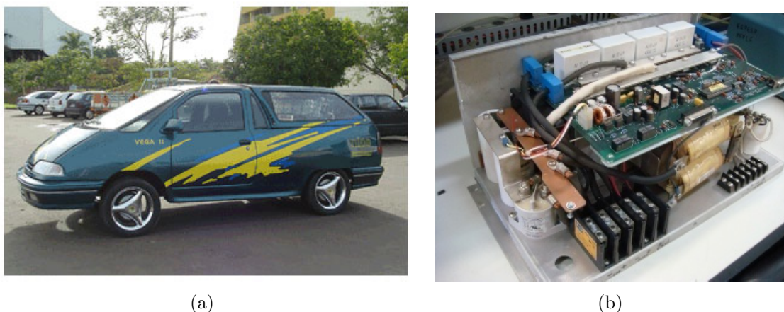
Figura 5: Veículo elétrico VEGA (UNICAMP): (a) Foto do veículo; (b) Detalhe dos conversores utilizados na gestão de energia do veículo.
