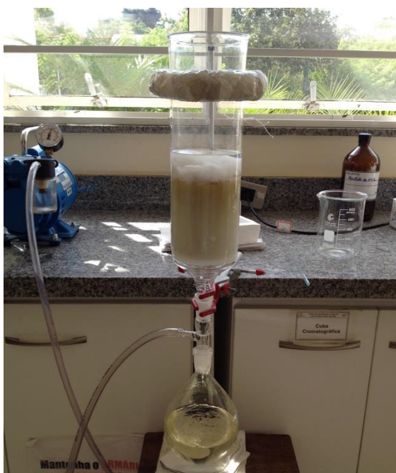
Figura 11– Fotografia do processo de Cromatografia Líquida à Vácuo.
