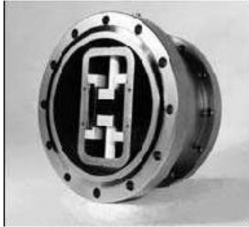
Figura 3.7: Foto do Filtro de Wien do acelerador tandem.
