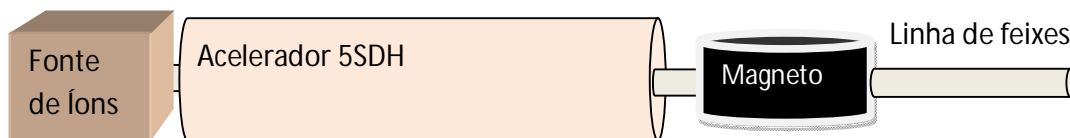
Figura 3.1: Vista lateral dos equipamentos. Fonte de íons, Acelerador, Magneto e Linhas de feixes.
