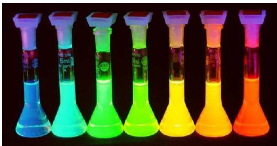
Figura 4-1: Emissão de soluções contendo nanopartículas de semicondutor, o tamanho das nanopartículas cresce da esquerda pra a direita [28].
