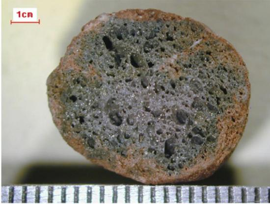
Figura 4.1: Seção do agregado leve do tipo 4/10 430 A (extraído de [86]).
