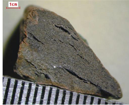
Figura 4.2: Seção do agregado leve do tipo 4/8 750 S (extraído de [86]).
