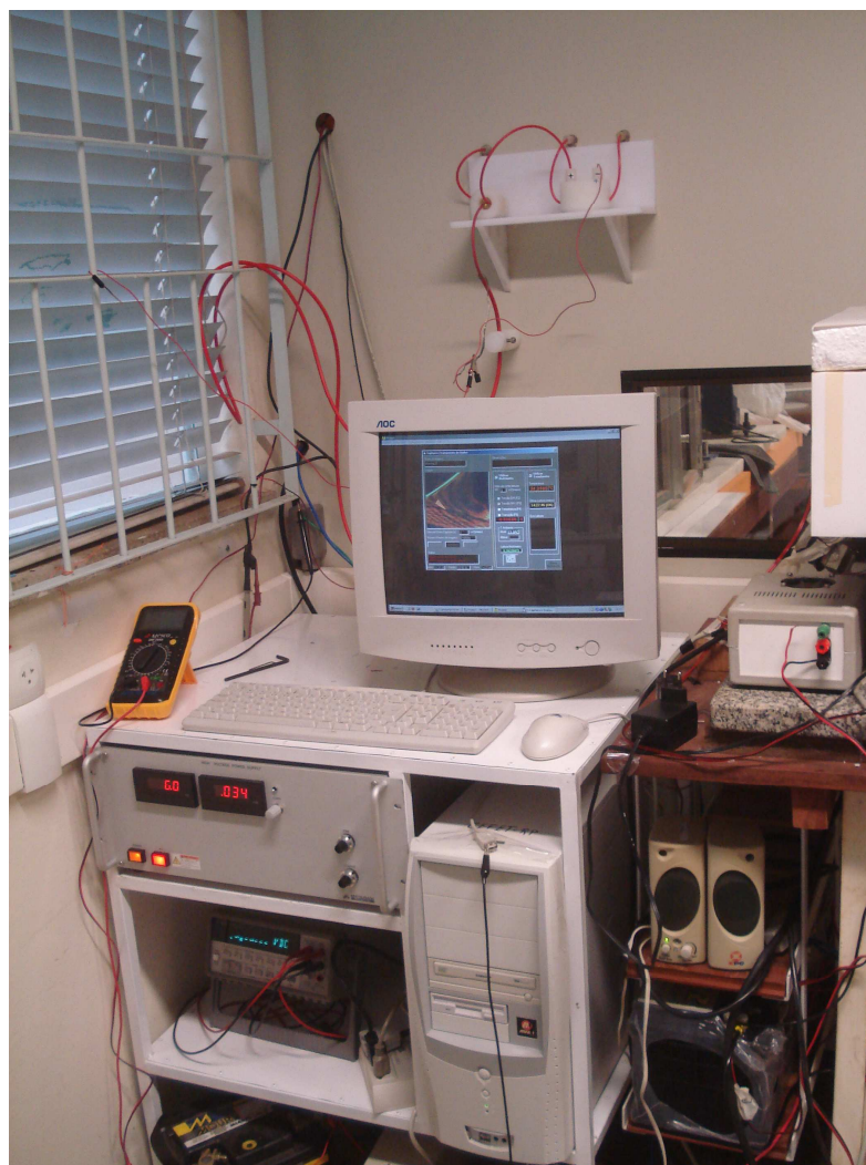
Figura 5: Console de controle utilizado nos ataques HF - SiO_2 . Afixado na parede (acima), o comutador de polaridade. Na bancada principal se vê o computador de aquisição de dados, a fonte de alta tensão, o voltímetro (abaixo) e as caixas do monitor de áudio (à direita). Ao fundo a janela de vidro que possibilita o contato visual com a sala do ataque.
