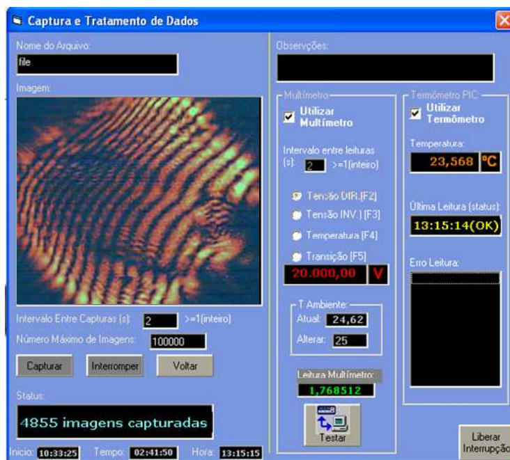
Figura 7: Tela do programa de aquisição de dados. Além de fazer a aquisição da imagem das franjas de interferência, o sistema registra, em tempo real, a temperatura da amostra e a tensão aplicada entre suas superfícies. A temperatura da sala é informada manualmente, via teclado. Existe ainda um campo de observação onde se pode digitar algum evento ocorrido durante o experimento
