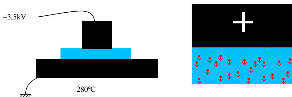
Figura 35: Migração de íons positivos da amostra de sílica após aplicação de alta tensão a alta temperatura. Formação da região de depleção acima da camada de cargas positivas.
