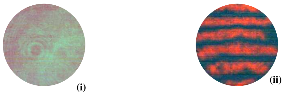
Figura 40 Comparação dos padrões de interferência gerados pelas reflexões nas duas faces da amostra. (i) antes e (ii) depois do ataque seletivo.
