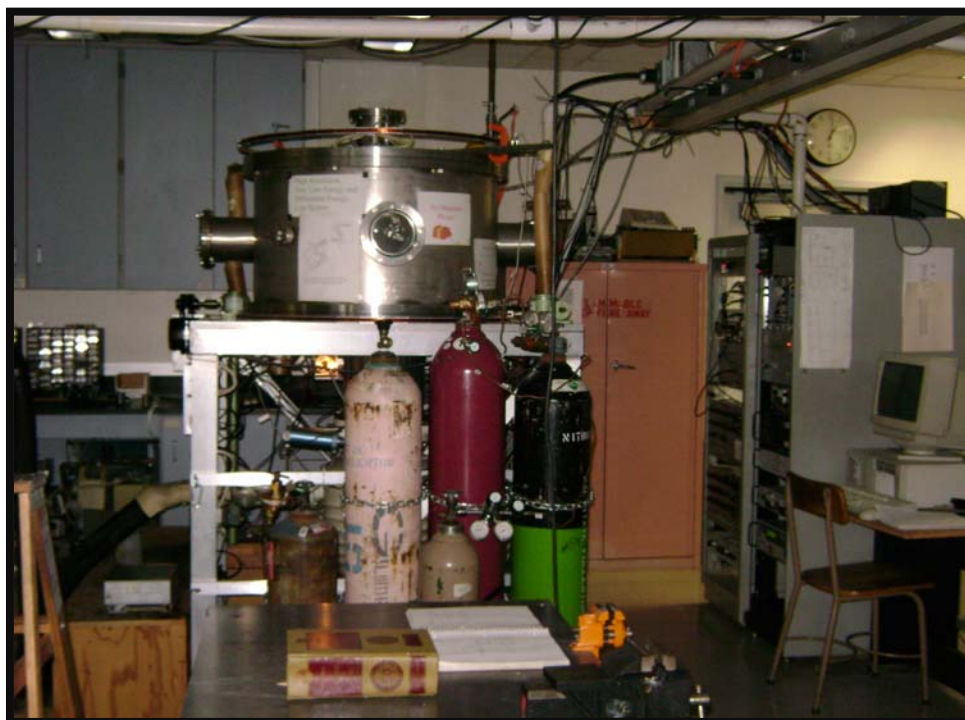
Figura 4.1: Espectrômetro de Perda de Energia de Elétrons construído no laboratório da CSUF.
