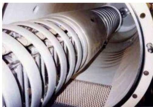
Figura 3.10: Foto ilustrativa com vista do interior do acelerador. No centro, temos o terminal de alta tensão.
