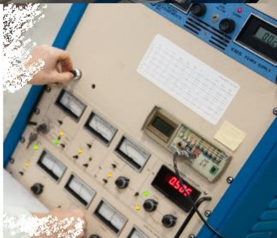
Figura 3.13: Parte (a), superior, esquema ilustrativo com vista superior do Magneto e das linhas de feixe. Na parte (b), uma foto ilustrativa com vista superior do acelerador, magneto e linhas de feixe. Na parte (c), o console do acelerador, onde é possível controlar a voltagem no seletor de velocidades, o valor do campo magnético e a energia do feixe de projéteis.
