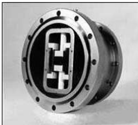
Figura 3.7: Foto ilustrativa do Filtro de Wien que faz parte do acelerador.
