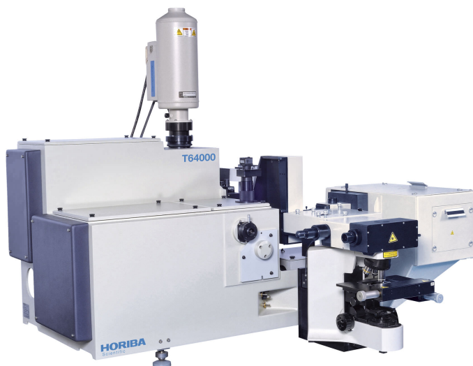
Figura 3.5 – Espectrômetro T64000 da Horiba Jobin Yvon equipado com um detector de carga acoplada (CCD) e um microscópio confocal BX41 da Olympus .
