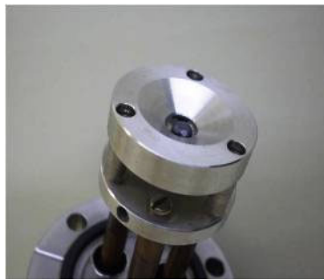
Figura 3.7: Cone metálico conectado acima da plataforma superior na estrutura interna da fonte termiônica (primeiro eletrodo do sistema de extração)
