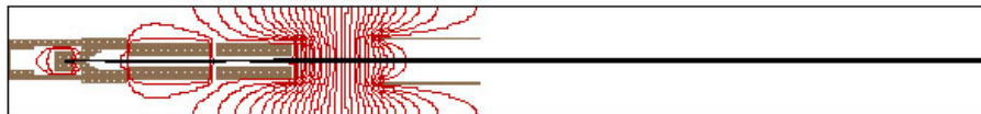
Figura 4.19: Simulação com lente de 2 elementos. Observe que o feixe não diverge ao longo do percurso.
