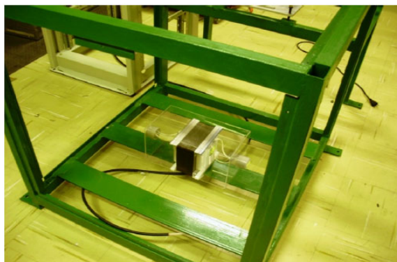
Figura 4.7: Vista lateral do rack externo com um dos transformadores de isolamento.
