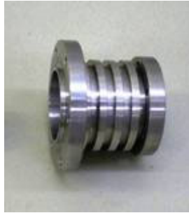
Figura 3.9: Cilindro metálico de conexão para a montagem do sistema de extração
