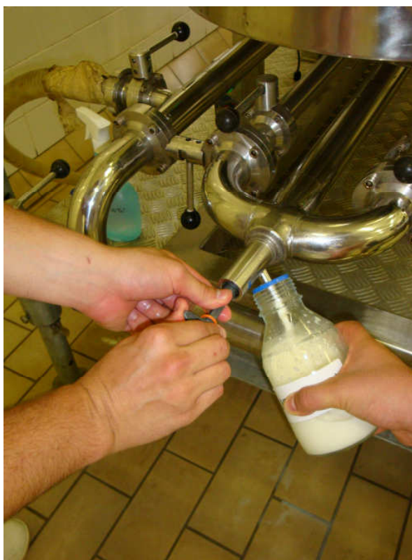
Figura 17 – Um dos pontos de coleta do equipamento UV da TECNOPURE ® /MONTEX ®
