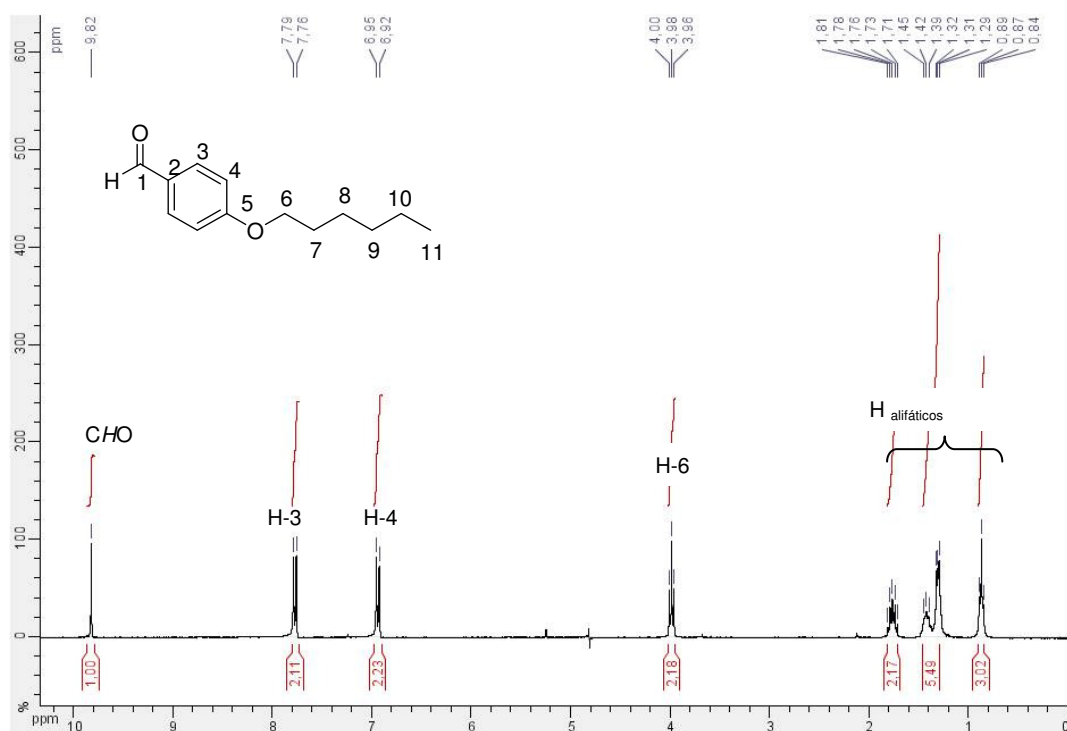
Figura 45: Espectro de RMN de ^1\text{H} ( \text{CDCl}_3 ; 300 MHz) do 4-(hexiloxi)-benzaldeído 10.
