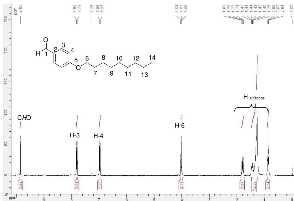
Figura 49: Espectro de RMN de 1 H (CDCl 3 ; 300 MHz) do 4-(noniloxi)-benzaldeído 12.
