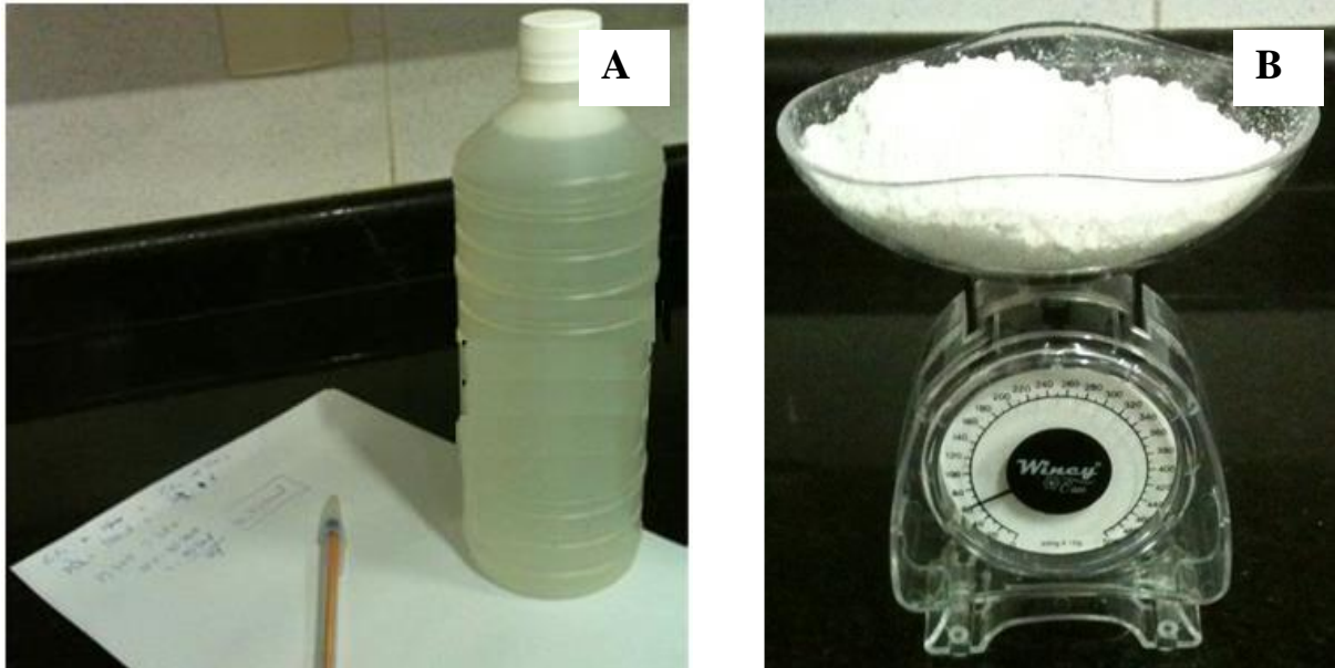
Figura 12: (A) Ácido Lático e (B) Carbonato de Cálcio utilizados na armadilha de CO_2 .
