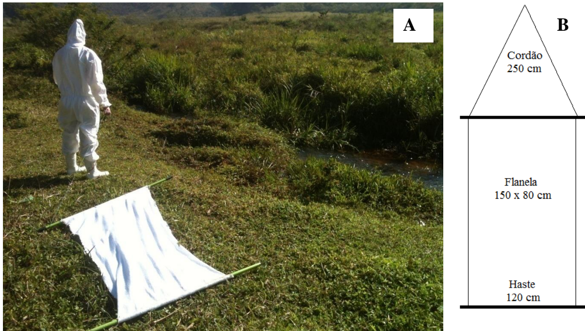
Figura 9: (A) Arrasto de flanela sobre a vegetação para coleta de carrapatos e (B) Medidas para confecção do arrasto.
