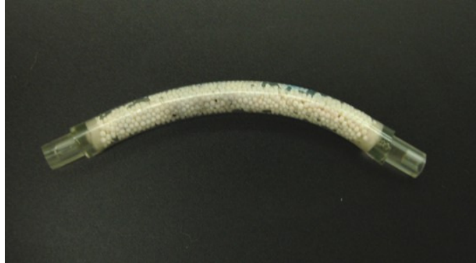
Figura 15: Reator tubular com a enzima peroxidase immobilizada.
