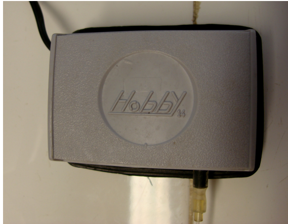
Figura 18: Mini-compressor tipo “bomba de aquário” utilizado para propelir as soluções e reagentes durante a análise em fluxo.
