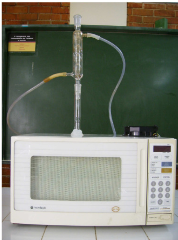
Figura 5.1. Foto do forno de microondas adaptado.
