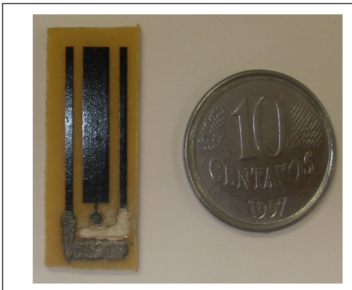
Figura 7. Eletrodo impresso de cobre e seu tamanho relativo a uma moeda.
