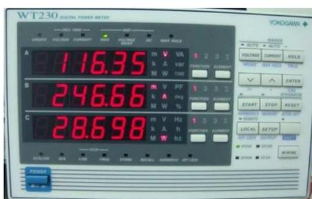
Figura 78 – Medições de tensão, corrente e potência na carga usando o WT230-*Yokogawa*.
