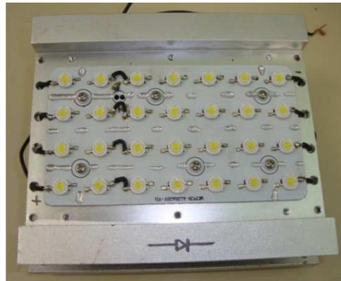
Figura 3 – Luminária LED adotada como carga.
