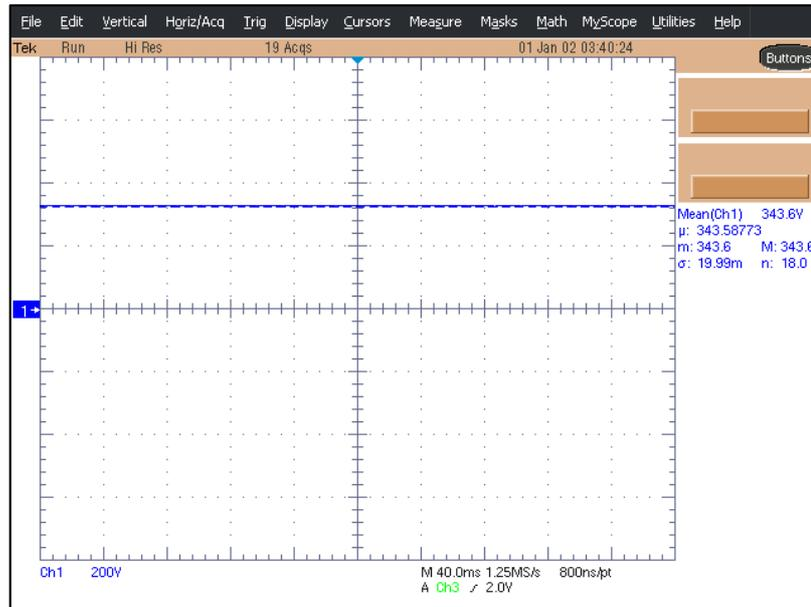
Figura 67 – Tensão no resistor do circuito *snubber*.
