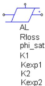
**Figura 96 – Elemento de núcleo saturável no PSIM.**
