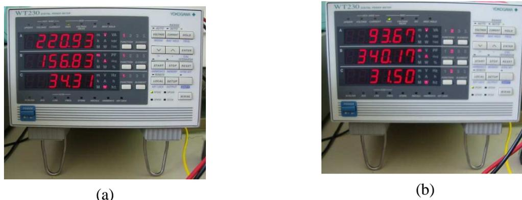
**Figura 62 – Valor eficaz de tensão, corrente e potência com o WT230-Yokogawa.**
