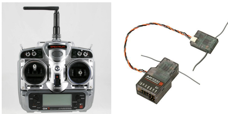
Figura 39: Rádio transmissor e rádio receptor
