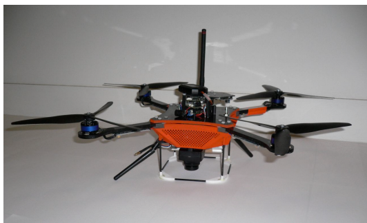
Figura 5: Exemplo de um VAANT (Multicóptero) utilizado para realizar busca e salvamento (WAHARTE; TRIGONI, 2010)
