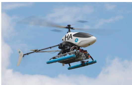
Figura 3: Exemplo de um VAANT utilizado para realizar inspeção de linhas de transmissão de energia (HRABAR; MERZ; FROUSHEGER, 2010)
