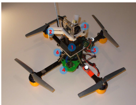
Figura 10: Exemplo de um VAANT (Quadrícóptero) utilizado para realizar mapeamento de ambientes (BACHRACH; HE; ROY, 2009)
