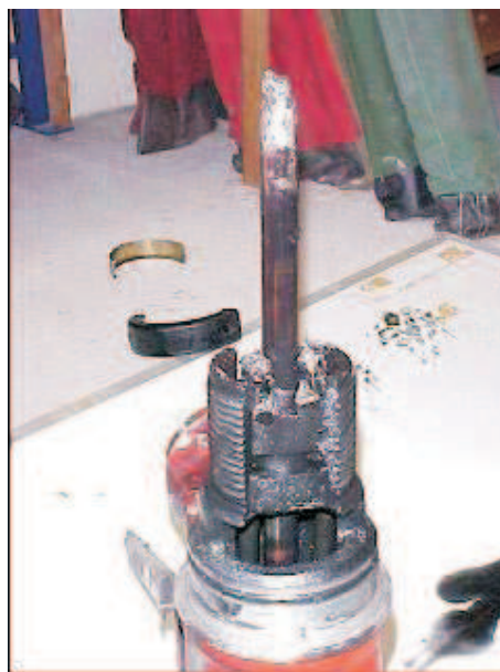
Figura 1.1: Pólo de um disjuntor PVO danificado. (Mamede 2004)
