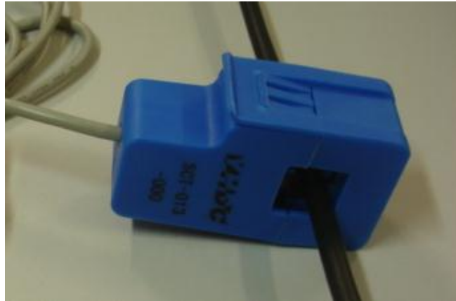
Figura 20 – Transformador de corrente.
