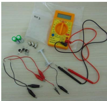
Figura 5.10: Kit para a atividade experimental sobre circuitos e medidas elétricas [Fonte: Autor].
