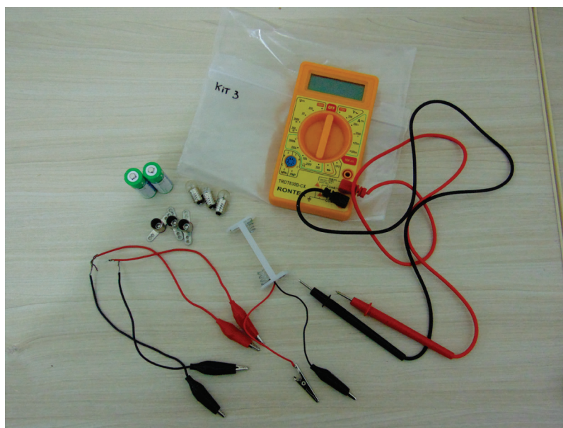
Figura 6.6: Kit para a atividade experimental sobre circuitos e medidas elétricas.
