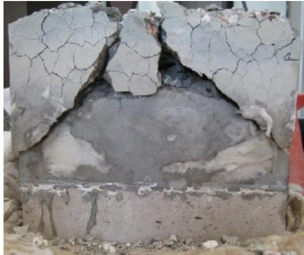
Figura 2.3: Deterioração de um corpo-de-prova por “spalling”, extraído de FERREIRA (2011, [1]).
