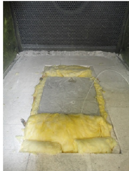
(b) Corpo-de-prova dentro do forno isolado com lã de vidro
