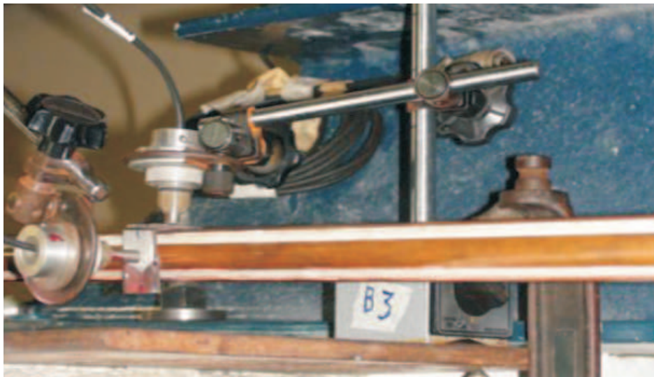
Figura 5.16: Estrutura tubular preparada para o ensaio. Extraído de [31].
