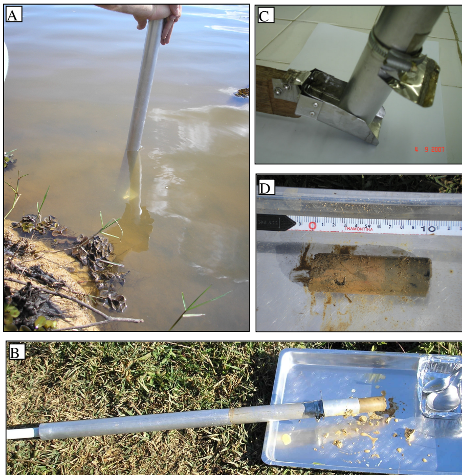
FIGURA 3.2: Detalhes do coletor desenvolvido e sua aplicação em campo. A - Inserção do tubo no sedimento; B - Extrusão do sedimento; C - posição de encaixe da pá sustentação; D - aspecto de uma amostra após a retirada do tubo.
