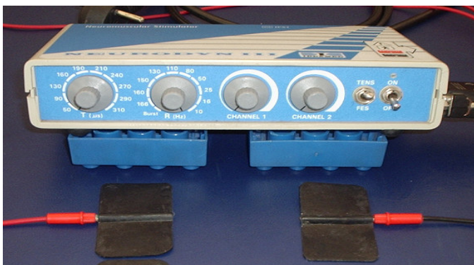
Fig.2- Aparelho de Eletroestimulação Transcutânea do Nervo (TENS). Neurodyn III Fonte: Clínica de Fisioterapia da UNIG-Campus V. FARIA, E. (2005).
