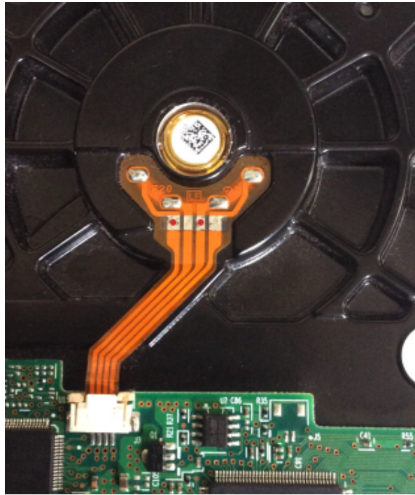
Figura 16 – Sugestões marcadas em vermelho para a soldagem dos contatos da saída de áudio.
