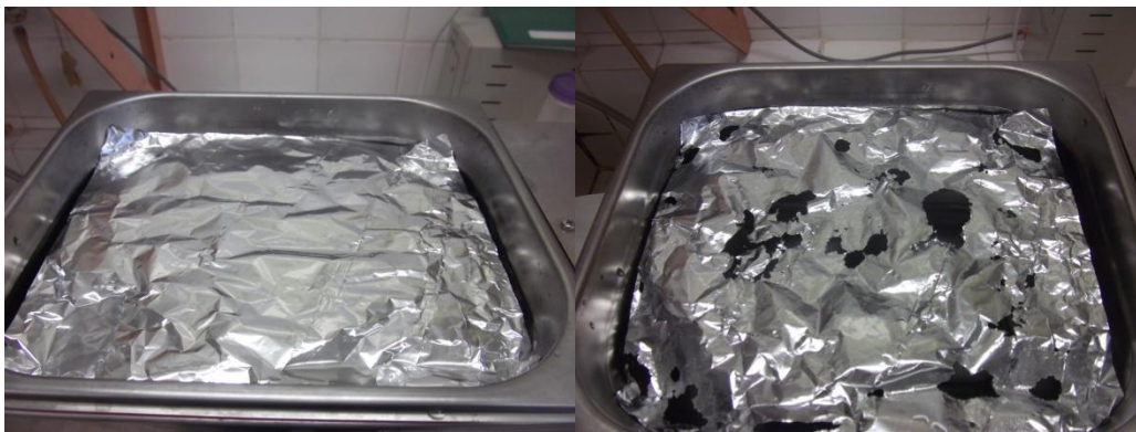
Figura 4: “Mapeamento” do banho de ultrassom.
