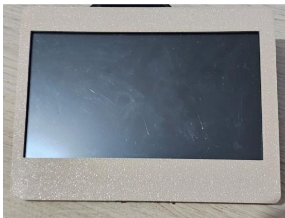
Figura 11 - Tela IPS touchscreen de 7 Polegadas 1024x600 pixels
