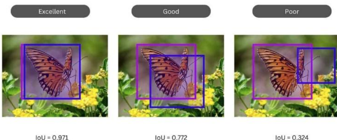
Figura 5 - Representação visual da métrica IoU em detecção de objetos
