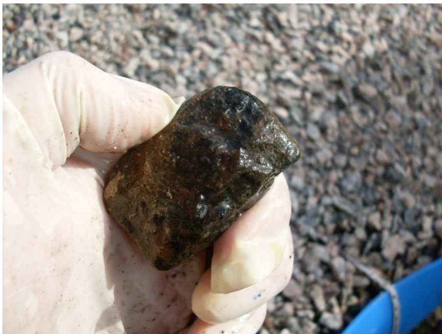
Figura III.4 – Aspecto limoso da brita # 3 utilizada para melhorar o fluxo hidráulico na saída dos SACs onde fez-se uso de areia, indicando a formação evidente do biofilme após 45 dias de operação.
