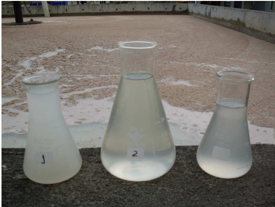
Figura III.6 – Ao fundo, tanque de equalização onde foi retirada a ARL, frasco 1 (esquerda para direita), afluente do tanque de distribuição sem excesso de gorduras, frasco 2 e 3 (ao centro), ARL tratada, após um ciclo de dois dias.
