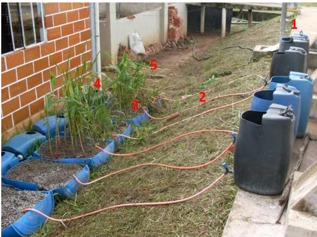
Figura 4.6 – Distribuição do efluente nos SACs: Seqüência do tratamento
