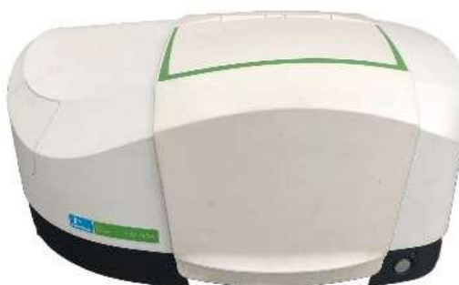
Figura 4 - Espectrômetro de Infravermelho da Perkin Elmer, modelo Spectrum Two™, com transformada de Fourier
