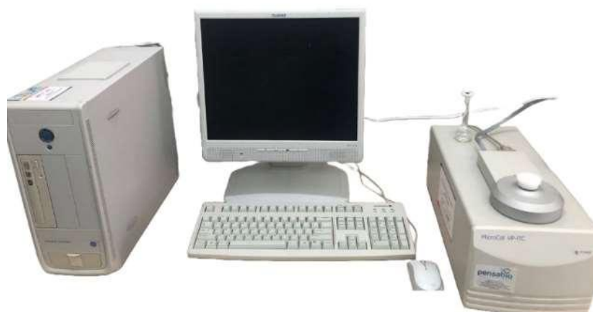
Figura 6 – Representação do Microcalorímetro VP-ITC da Microcal
