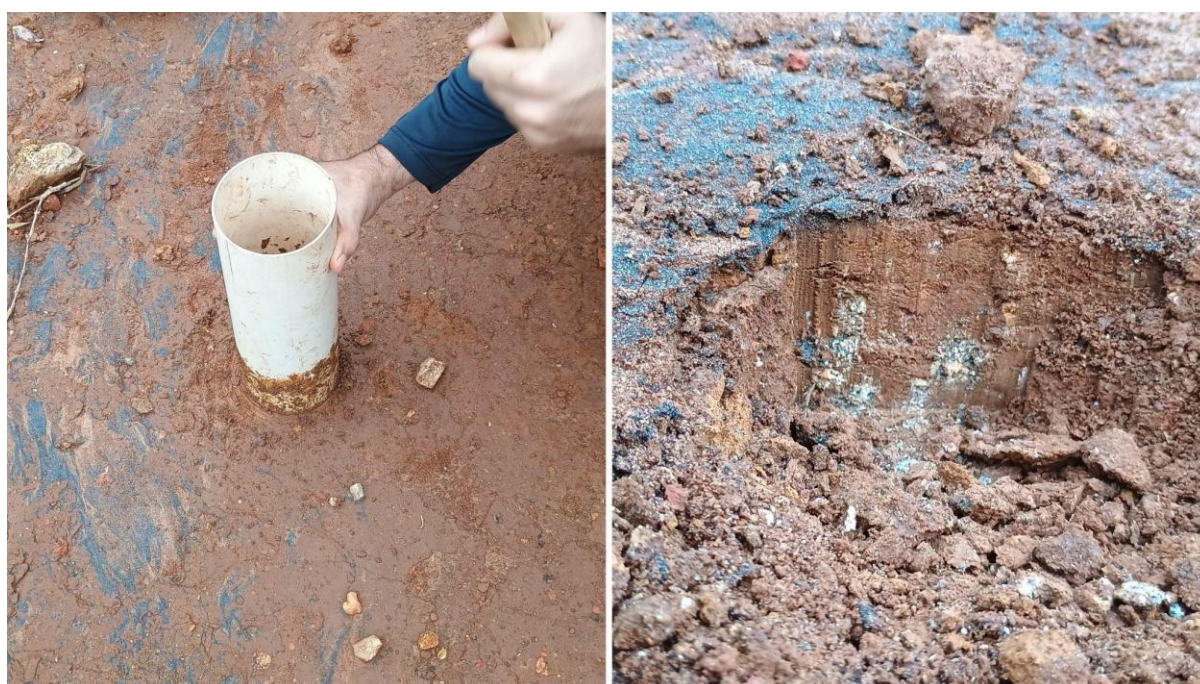
Figura 39 - Tentativa mal sucedida de instalação do equipamento para a estimativa de infiltração da água na zona de recarga da nascente N09, por conta da compactação do solo.
