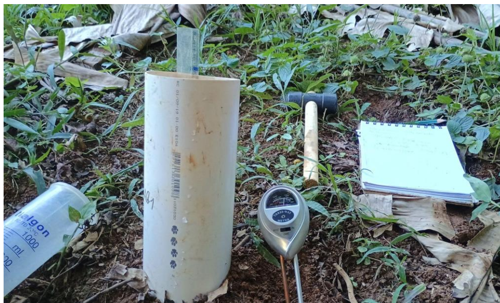
Figura 8 - Equipamentos utilizados para medição da Taxa de Infiltração e Umidade do solo.
