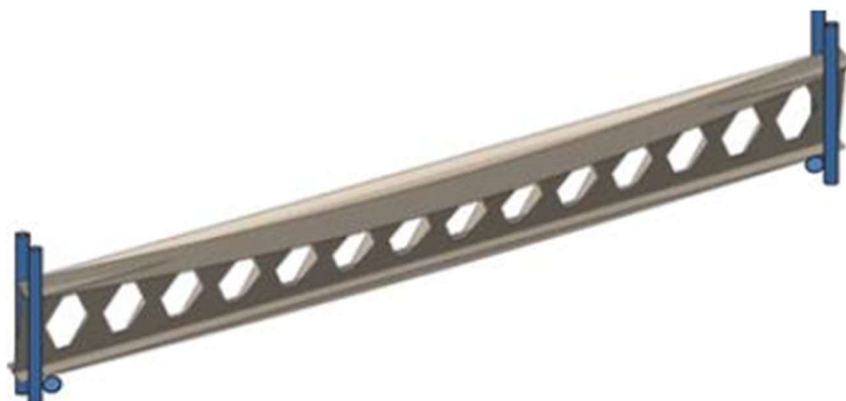
Figura 20 - Flambagem Lateral com Torção
