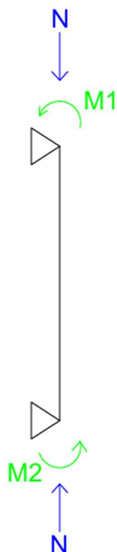
Figura 44 - Modelo Estrutural Adaptado para os pilares celulares
