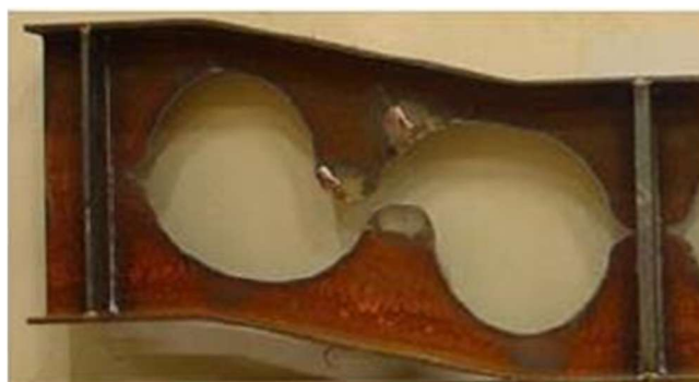
Figura 23 - Escoamento do Montante de Alma na junta soldada
