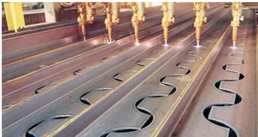
Figura 8 - Cortes efetuados por Máquinas CNC
