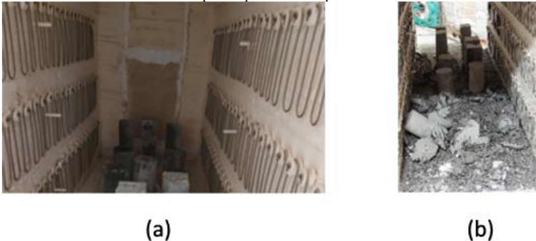
Figura 24 - Amostras de UHPC no forno: (a) antes do aquecimento; (b) após exposição a 600 °C, sendo os corpos de prova atrás aqueles com MJ.
