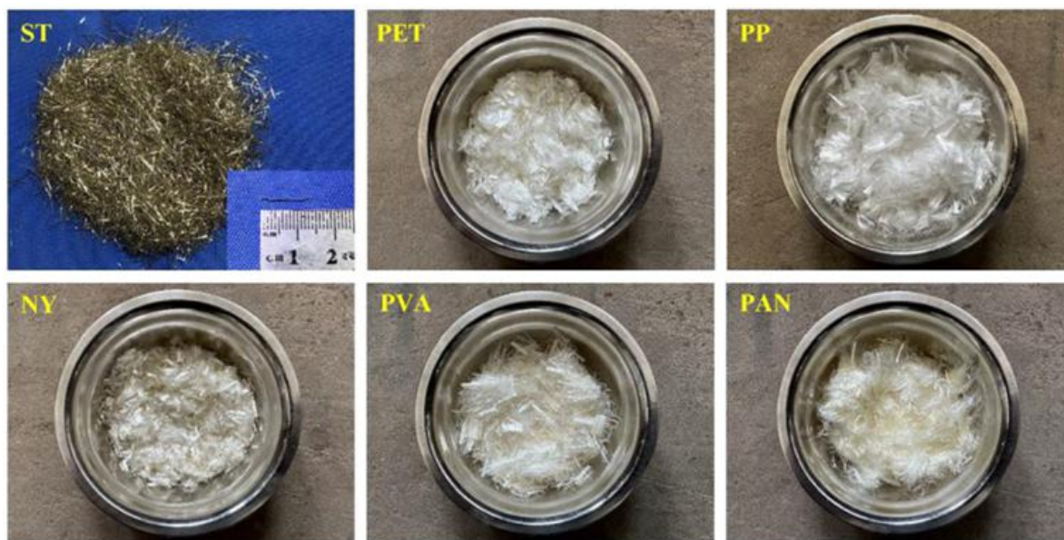
Figura 2 - Aparência das fibras de aço e sintéticas.
