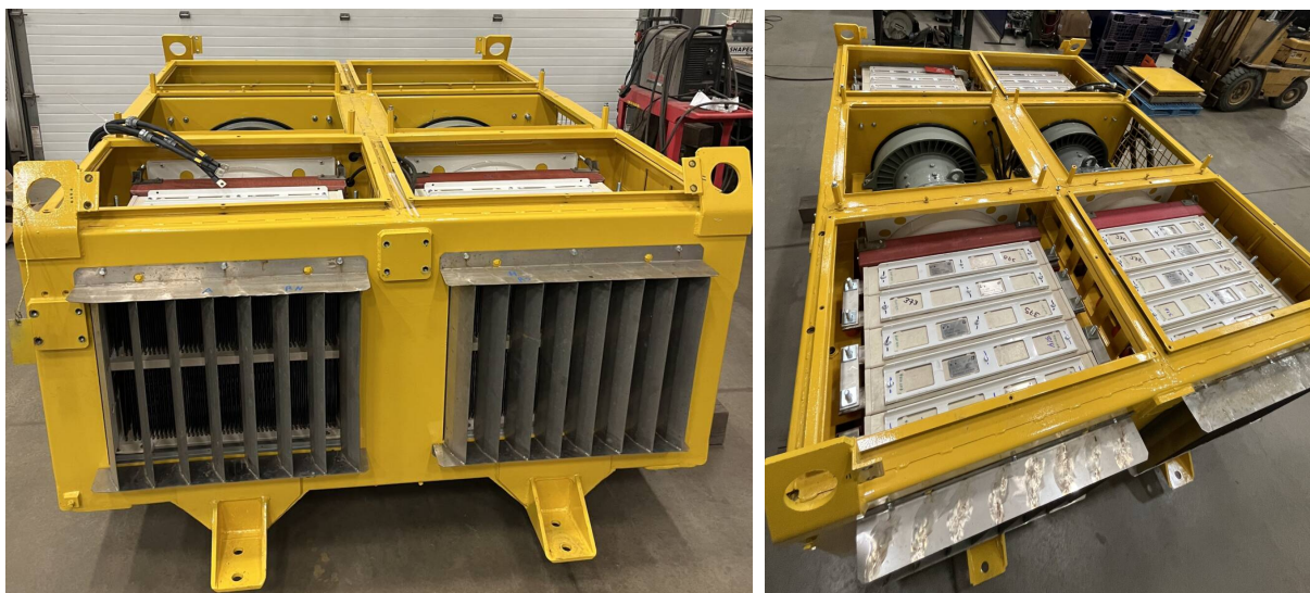
Figura 2.15 – Vistas frontal e superior do banco de frenagem dinâmica, evidenciando os sopradores centrais responsáveis pela refrigeração por convecção forçada nas grades resistivas.
