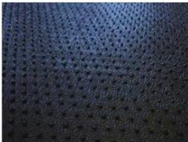
Figura 1 - Exemplo de geomembrana texturizada por matriz plana
