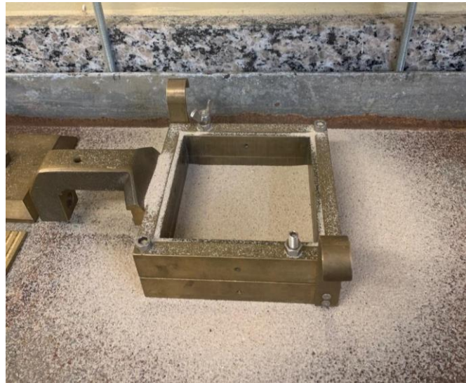
Figura 27 - Caixa de cisalhamento direto sendo preenchida por areia
