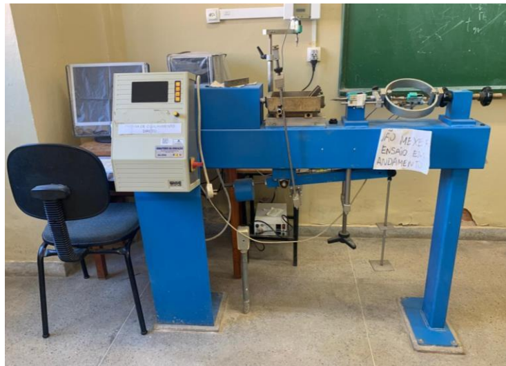
Figura 28 - Equipamento de Cisalhamento Direto
