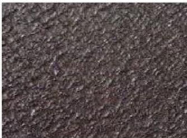
Figura 2 - Exemplo de geomembrana texturizada por matriz balão
