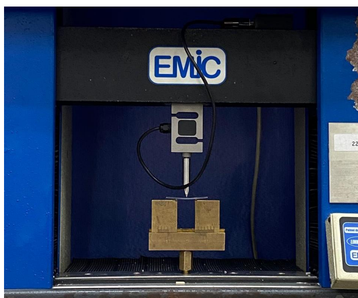
Figura 6 – Teste de resistência à flexão de três pontos. Máquina de testes universal posicionada no centro da amostra.
