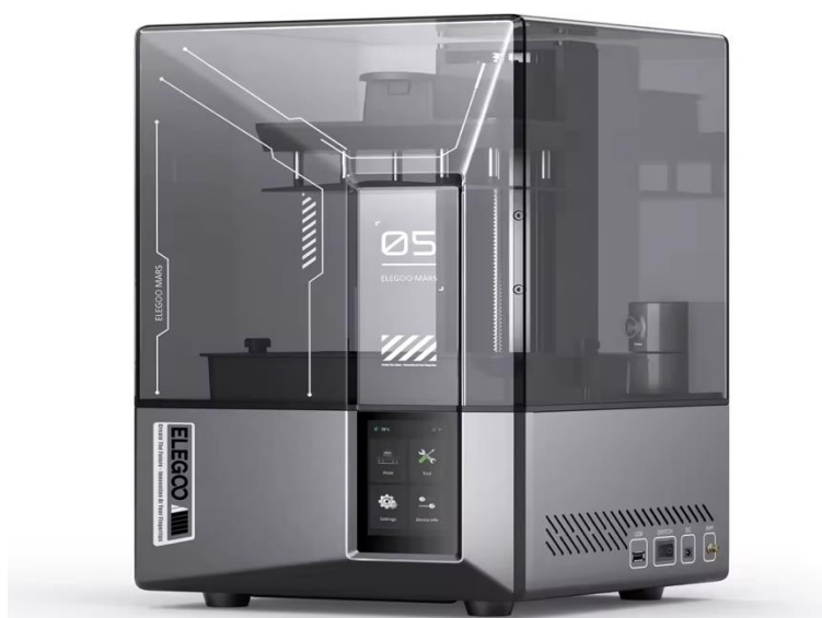
Figura 4 – Impressora 3D do tipo LCD Elegoo Mars 4 Ultra utilizada na confecção das amostras RI.
