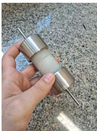
Figura 6 - Sistema de eletrodos bloqueadores de inox utilizado para análise de impedância
