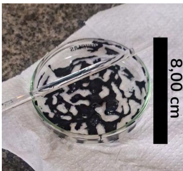
Figura 4 - Sólido de nanofibras de PANI-EB recolhido antes da secagem
