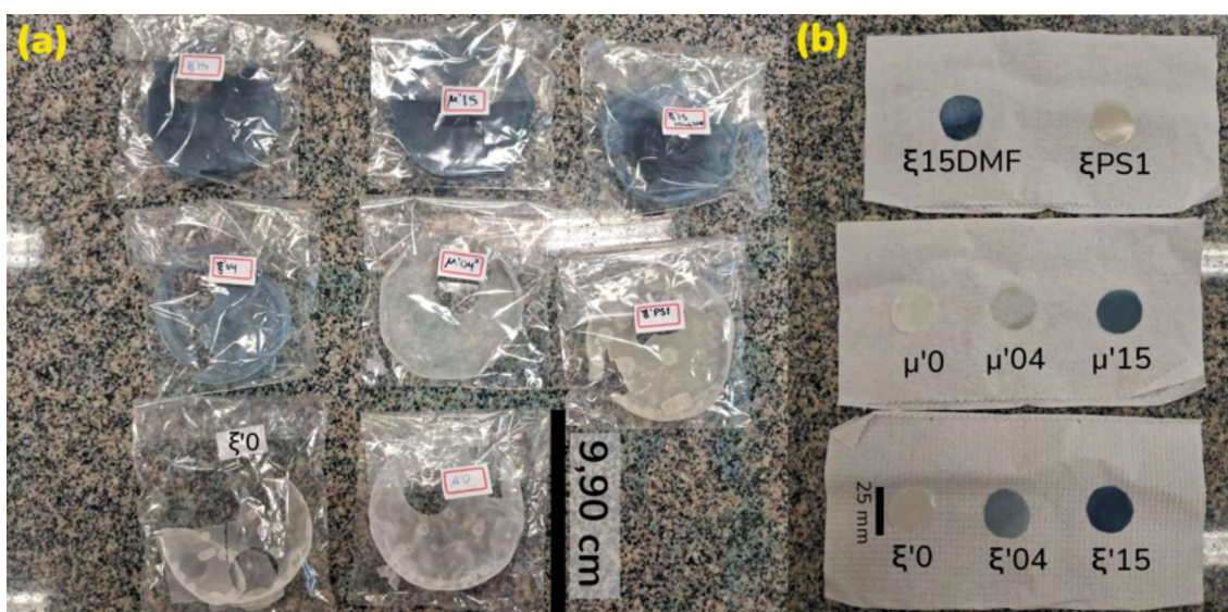
Figura 5 - Fotografias dos eletrólitos preparados: (a) filme completo preparado pela deposição nas placas de petri armazenados em sacos plásticos; (b) recorte dos filmes em discos de 25 mm para análise de impedância
