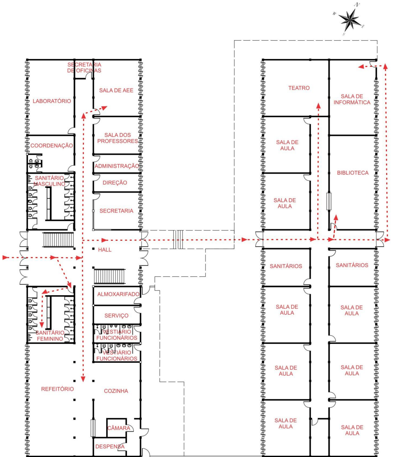
Figura 71: Percurso Walkthrough Pavimento Térreo (Fonte: a autora)
