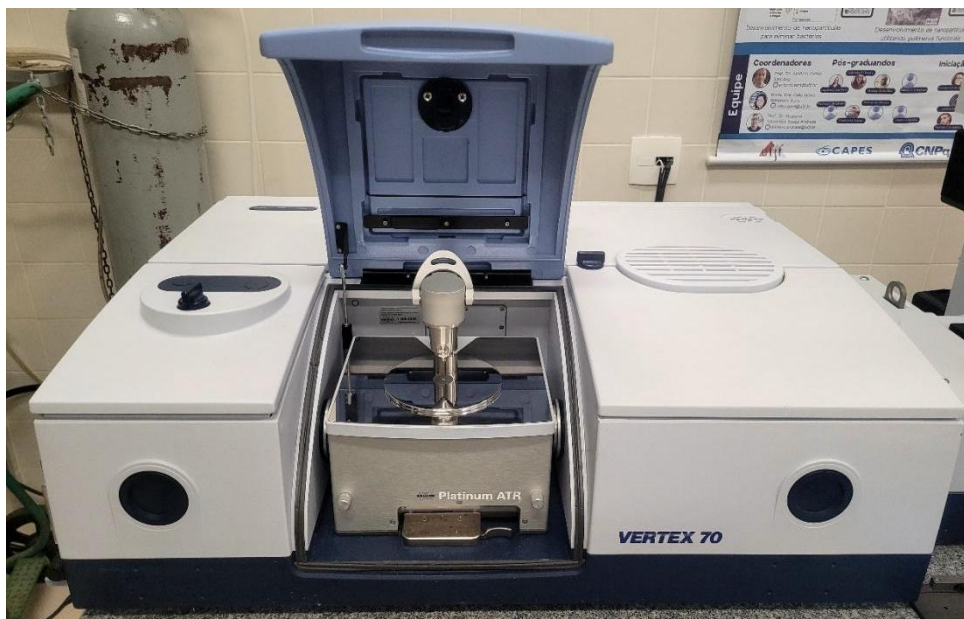
Figura 12 – Acessório de reflexão total atenuada acoplado ao espectrômetro de infravermelho.
