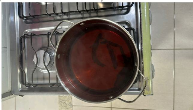
Figura 21: Processo de extração do tanino através do barbatimão
