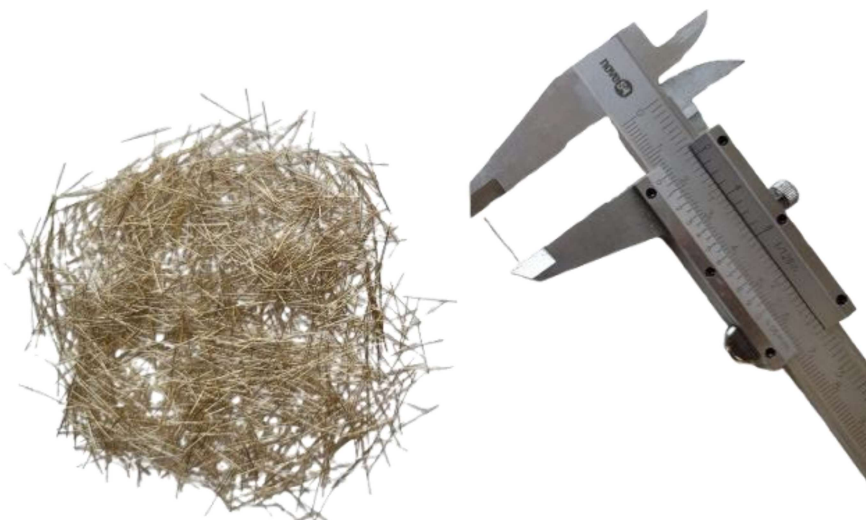
Figura 3 – Fibras de aço (diâmetro 0,2 mm e comprimento 13 mm)
