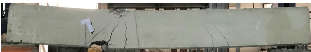
Figura 33 – Modo de falha experimental
