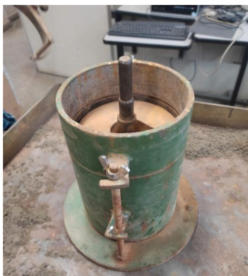
Figura 23 – Banho térmico no PTM adaptado. a) corpo de prova com sobrecarga; b) corpo de prova submerso.
