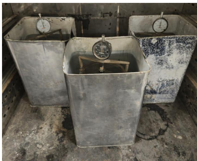
Figura 23 – Banho térmico no PTM adaptado. a) corpo de prova com sobrecarga; b) corpo de prova submerso.
