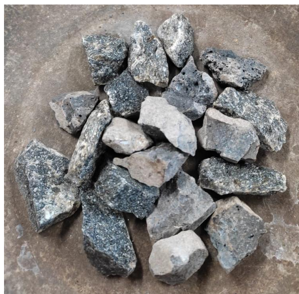
Figura 24 - Ensaio de impacto; a) aparelho treton; b) amostra da mistura de escória e brita com 20 fragmentos
