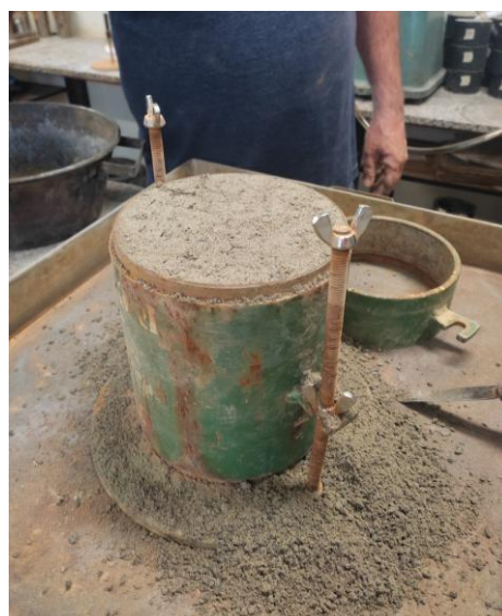
Figura 22 - Corpo de Prova para ensaio PTM adaptado. a) Procedimento de montagem; b) Montagem finalizada
