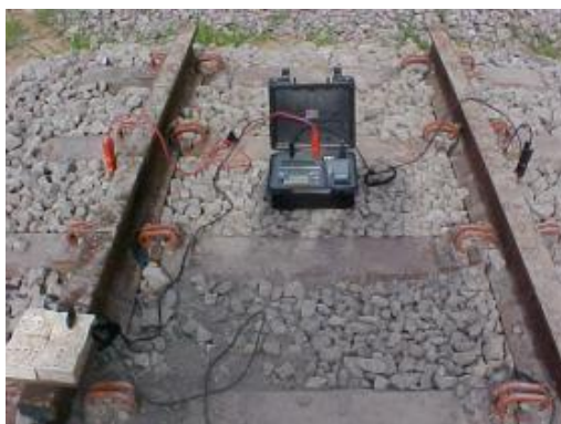
Figura 14 - Resistividade elétrica do trilho medida por megômetro
