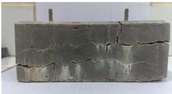
Figura 7 - Bloco de pavimentação produzido com escória de siderurgia sem tratamento
