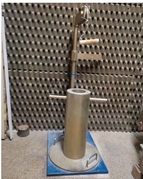
Figura 24 - Ensaio de impacto; a) aparelho treton; b) amostra da mistura de escória e brita com 20 fragmentos
