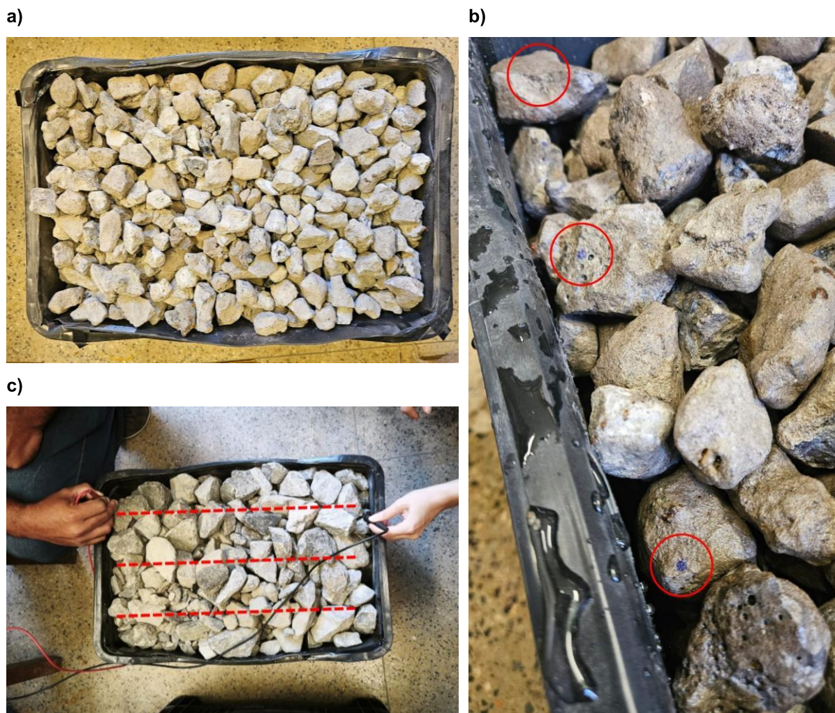
Figura 28 – Amostra para o ensaio de resistividade. a) amostra de escória seca; b) pontos fixos de medição marcados; c) medição com megôhmetro
