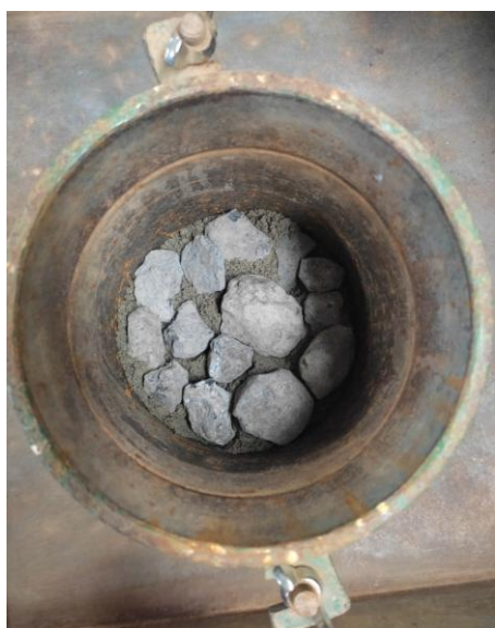
Figura 22 - Corpo de Prova para ensaio PTM adaptado. a) Procedimento de montagem; b) Montagem finalizada
