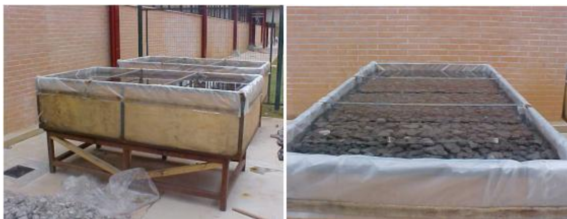
Figura 15 - Caixa-teste para avaliação dos efeitos da cura nas escórias de aciaria
