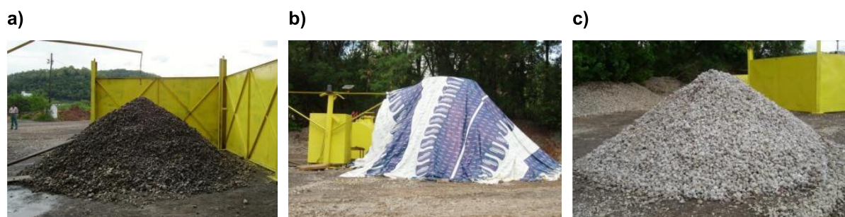
Figura 9 - Pilhas de escória de aciaria para tratamento. a) EH1, submetida apenas à hidratação; b) EH2, submetida à hidratação e à carbonatação; e c) controle (estabilização natural sob as intempéries)
