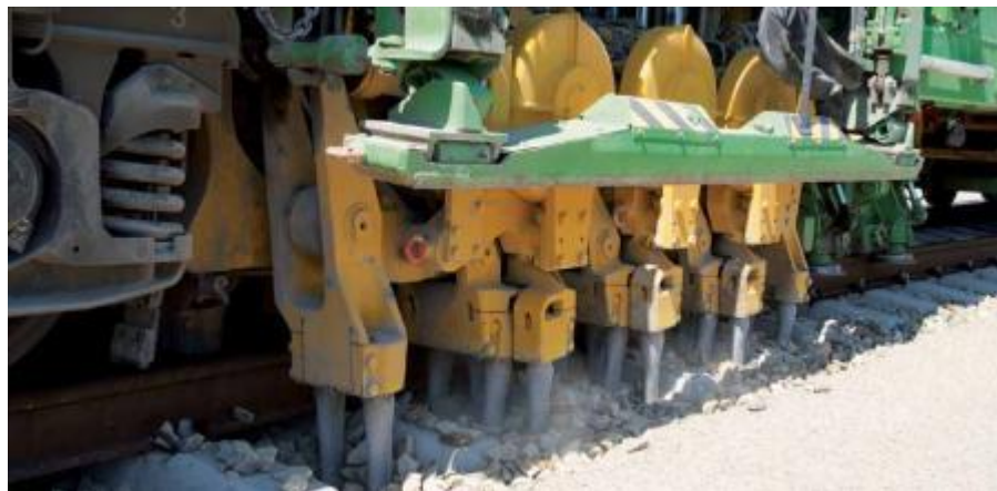
Figura 2 - Máquina socadora compactando quatro dormentes simultâneos
