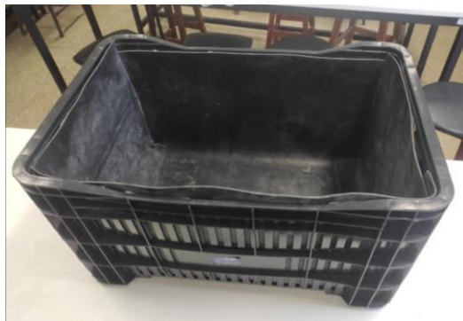
Figura 27 - Ensaio de resistividade elétrica. a) caixa plástica; b) caixa com tapete isolante
