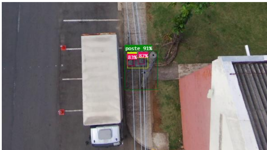
Figura 13 – Exemplo de inferência dos elementos do sistema elétrico com YOLOv8
