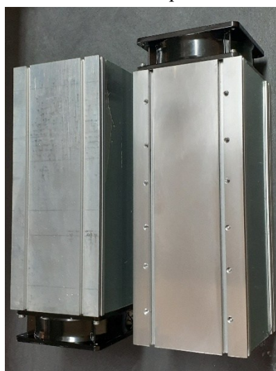
(a) Dissipadores de calor com ventilação forçada, um deles já usinado com furações, roscas e acabamento final para a montagem do estágio de potência.
