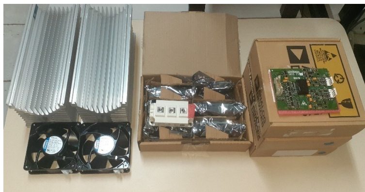
(a) Dissipadores de calor P3/250 com ventilação forçada, módulos IGBT SKM150GM12T4G e circuitos de acionamento SKHI 23/17R.
