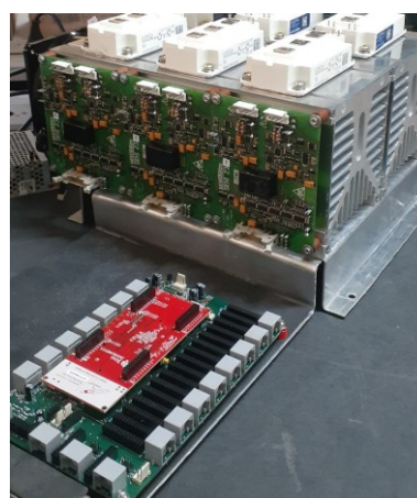
(b) Montagem da placa de controle DSPMB_Launchxl_F28379D_V1 sobre a chapa metálica de suporte, utilizando material isolante emborrachado para prevenção de curto-circuitos.
