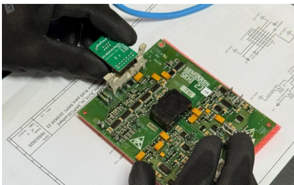
(a) Conexão da placa adaptadora ao conector de entrada do circuito de acionamento.
