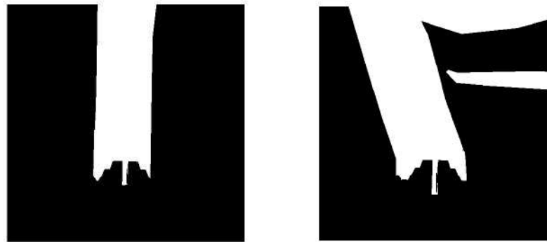
Figura 15 – Imagens binárias da segmentação por cor do braço inclinado 20^\circ à esquerda e antebraço reto: (a) antebraço; (b) braço.
